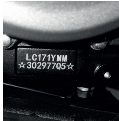
Номер двигателя, расположен слева под левой крышкой двигателя (крыш- кой генератора)
