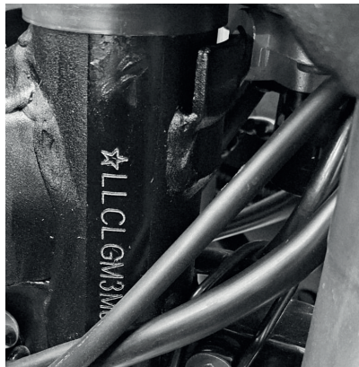
Расположение заводской таблички и (VIN). Находится на рулевой колонке слева и справа
