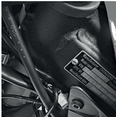
Расположение заводской таблички и (VIN). Находится на рулевой колонке слева и справа
